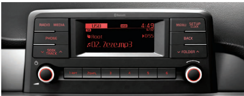
Аудиосистема Аудиосистема с функцией RDS включает плоский монохромный ЖК-экран TFT. Помимо радио, он предлагает возможность подключения к портативным устройствам через порт USB.
