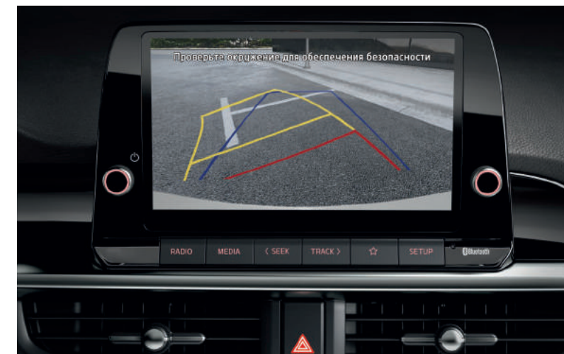
Камера заднего вида с динамическими направляющими Когда Вы заезжаете задним ходом на парковочное место, водонепроницаемая задняя камера проецирует на 8-дюймовый дисплей изображение вместе с динамическими указателями, показывающими направление Вашего движения.
