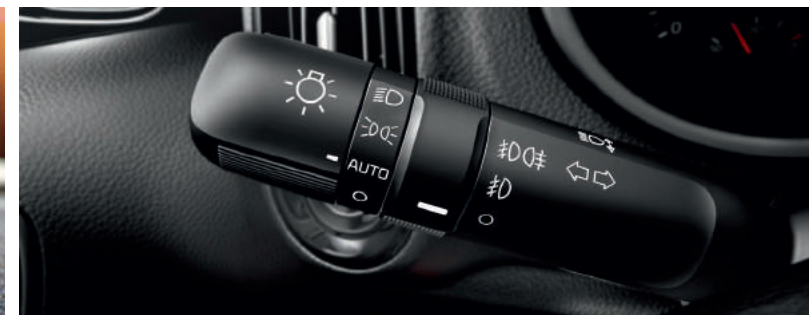
Автоматическое управление освещением Установите подрулевое кольцо в положение «авто», и передние и задние фонари будут включаться или выключаться в зависимости от освещения на улице.
